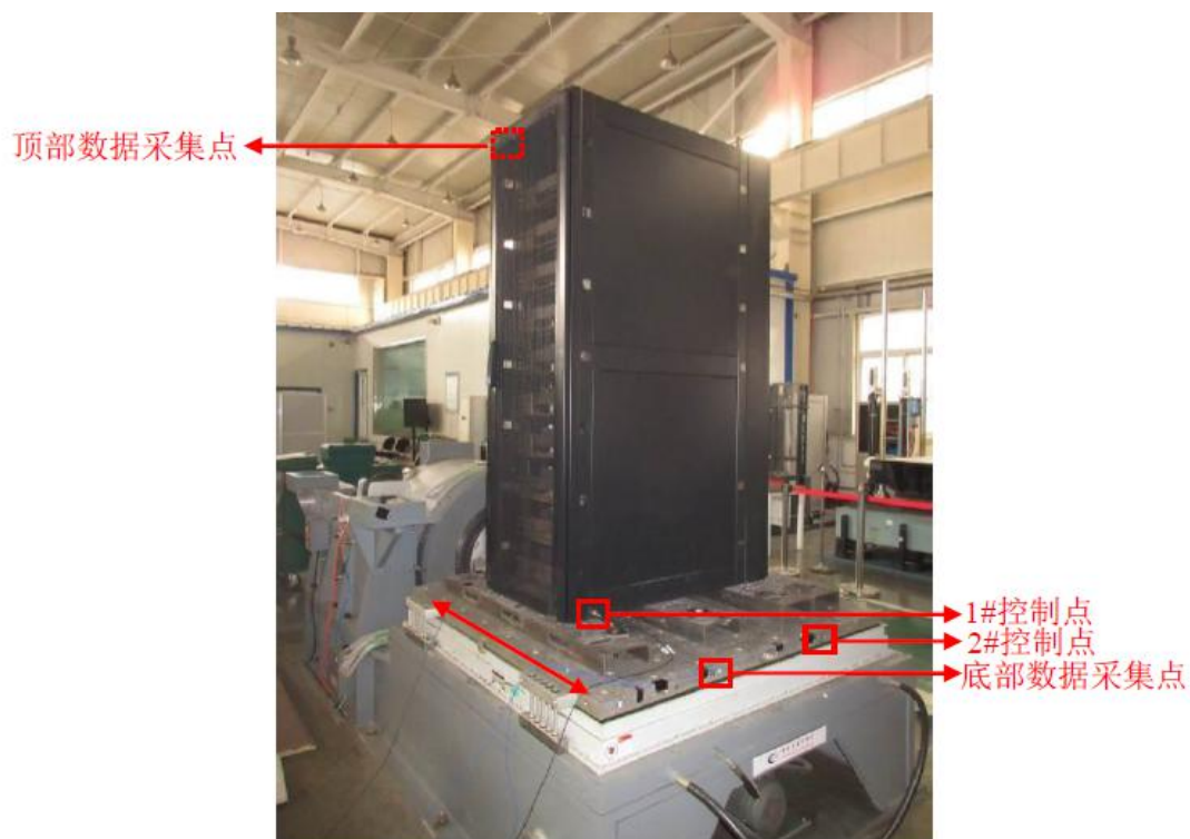
图 5：机柜动态测试现场照片
