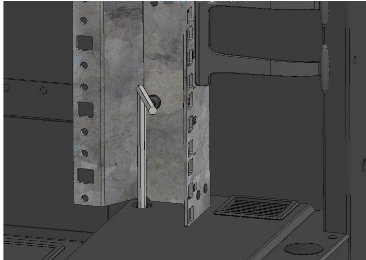
图 37：机柜内部调节支脚高度示意图
