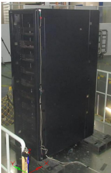
图 7：机柜抗震测试设备上照片
